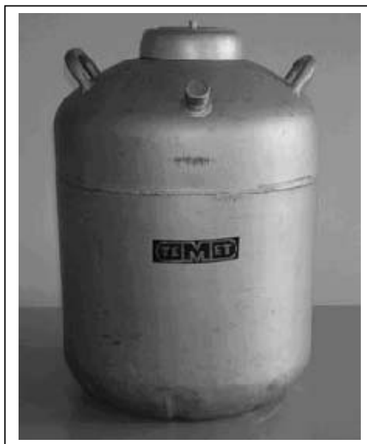
Рис. 3. Посудина Дьюару ХТ-35 – портативне кріосховище для спермопродукції жеребців
